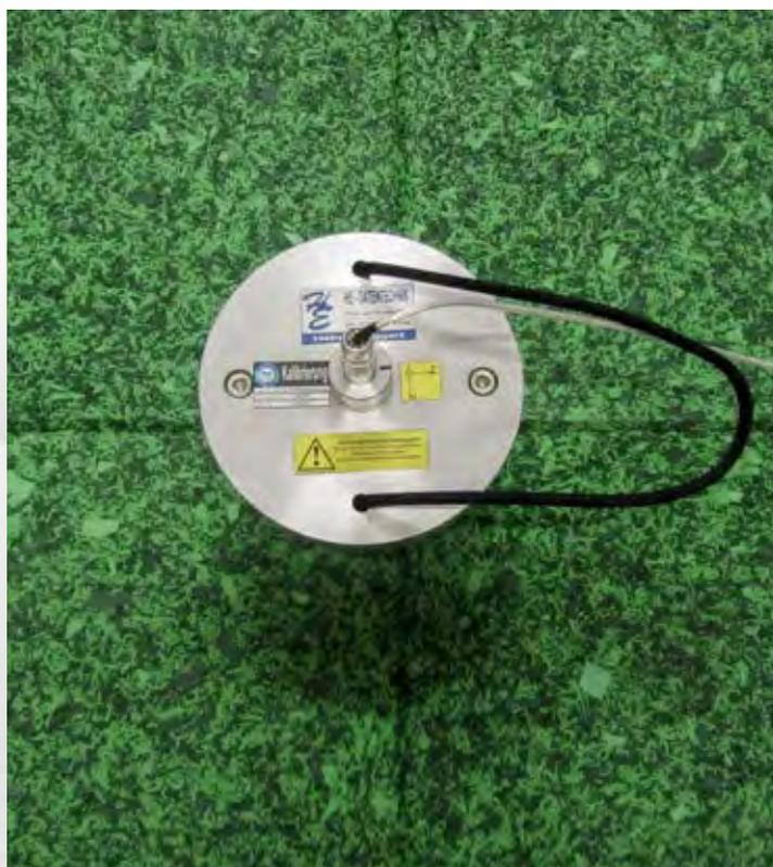
Alle EUROFLEX® Fallschutzplatten werden auf ihren HIC-Wert nach DIN EN 1177:2008 geprüft. Zudem sind sie nach ASTM-F-1292:2013 geprüft.
