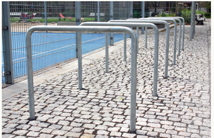
Fahrradgeländer ohne Knieholm hergestellt aus Stahlrohr 48x2,5 mm zum Einbetonieren, feuerverzinkt nach DIN EN ISO 1461 wahlweise pulverbeschichtet nach RAL oder DB.
