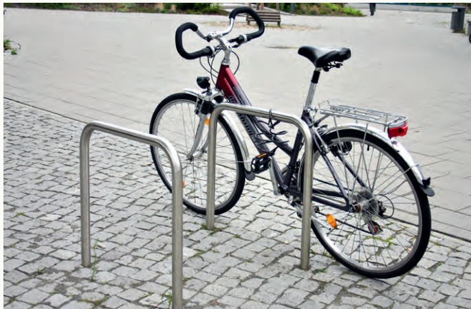
Fahrradgeländer ohne Knieholm hergestellt aus Edelstahlrohr 48x2,5 mm zum Einbetonieren.
